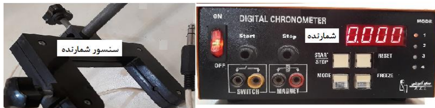
شکل (۵): زمان‌سنج دیجیتال و سنسور آن
