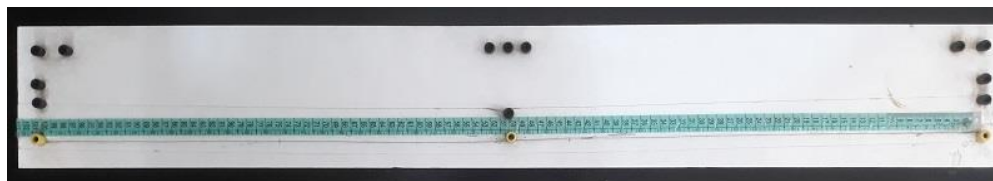
شکل (۶): یک سیم راست که به دو قسمت مساوی با طول l تقسیم شده است که به جای دو مقاومت معلوم R_1 و R_2 مورد استفاده قرار می‌گیرد.
