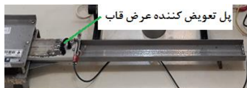
شکل (۴): کلید U شکل جهت تعویض عرض قاب
