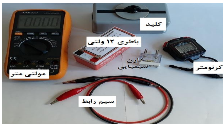
شکل (۵): وسایل مورد نیاز در آزمایش
