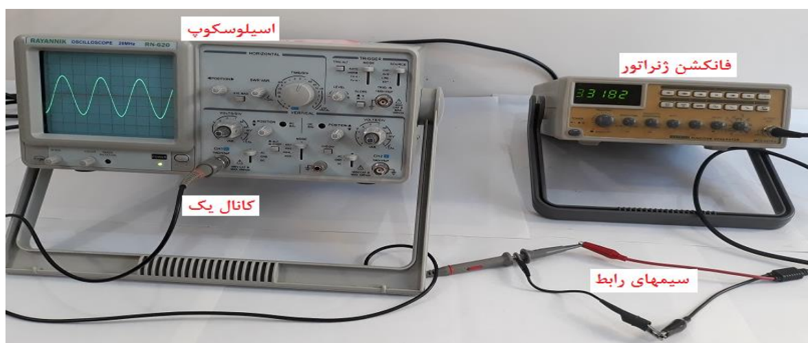
شکل (۵): خوانش اسیلوسکوپ
