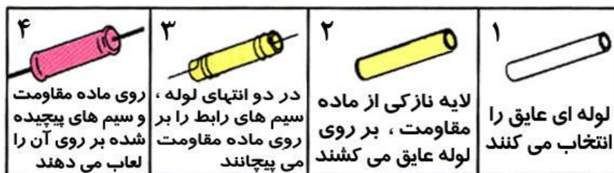
شکل (۵): مراحل ساخت مقاومت کربنی
