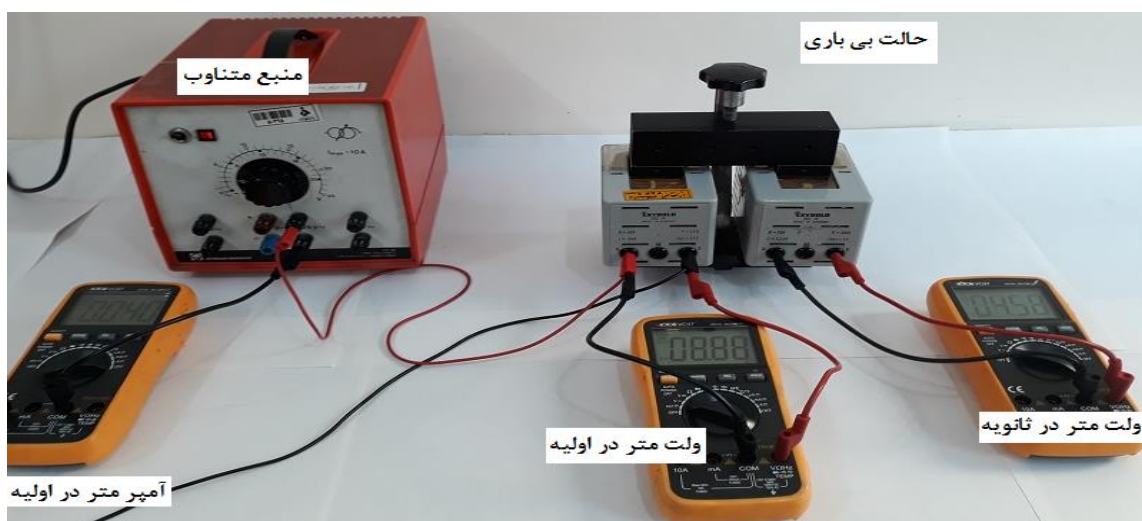
شکل (۸): مدار مربوط به ترانس بی بار (قسمت الف)
