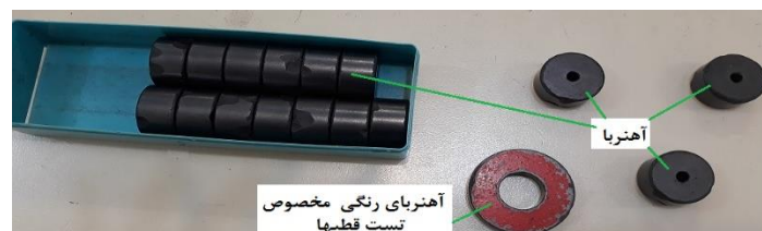
شکل (۲): آهنرباهای مورد استفاده در آزمایش همراه آهنربای تست
