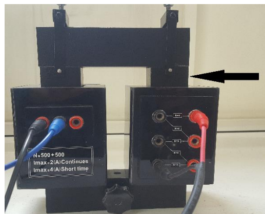
شکل (۲): ترانسفور متشکل از دو سیم پیچ که در یک یوغ آهنی بسته قرار دارند.
