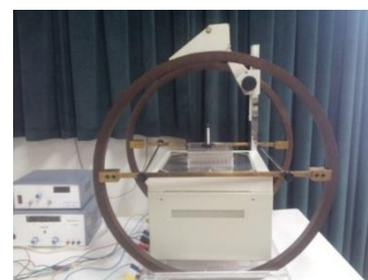
سیم پیچ های هلمهولتز و مجموعه نگهدارنده آنها (۱-a)
