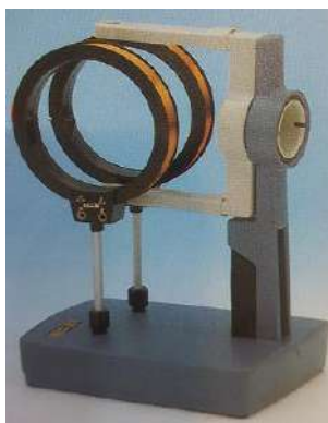
شکل ۱-۲: سیم‌پیچ‌های هلمهولتز، لامپ در فضای بین این دو سیم‌پیچ‌ها قرار می‌گیرد.
