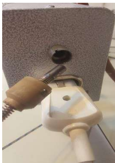
شکل (۶): محل قرار گرفتن سنسور ترموکوپل
