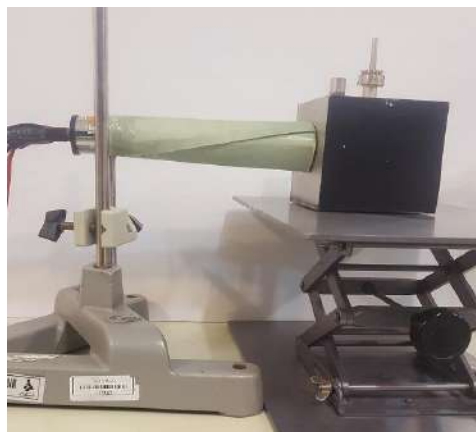
شکل (۳): بوسیله‌ی لوله مقوایی، تنها شار حرارتی عمود را به سمت ترموپیل هدایت می‌کنیم.
